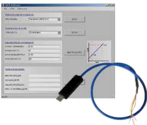
Una volta definito il range elettrico del segnale in ingresso ed il tipo (analogico o digitale), è possibile selezionare un'uscita standard ed associarvi uno specifico range di misura.
