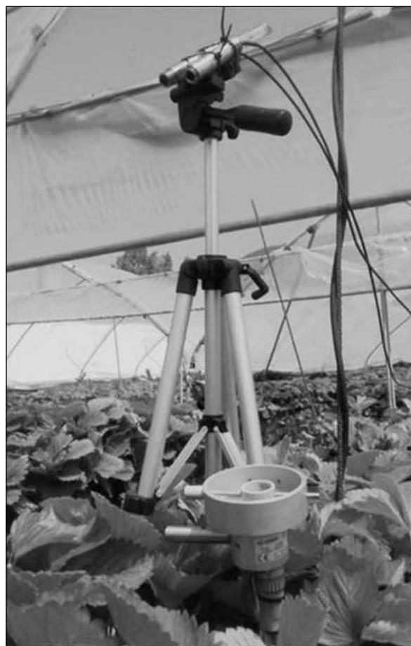
**Fig. 3** - Sensori di temperature IR e di bagnatura fogliare.
