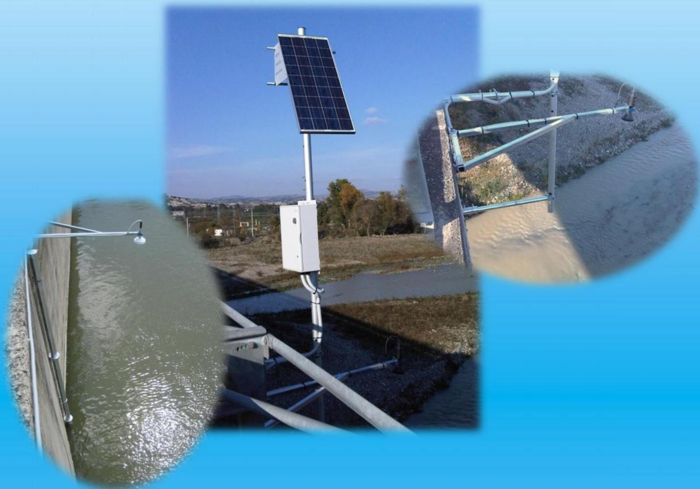
Le stazioni **ST-IDRO** sono realizzate ed utilizzate ai fini del **monitoraggio del rischio idrologico** o più semplicemente per il controllo dei livelli in bacini, dighe, laghi o fiumi, per il controllo dei fenomeni di esondazione, straripamento, piene improvvise.
